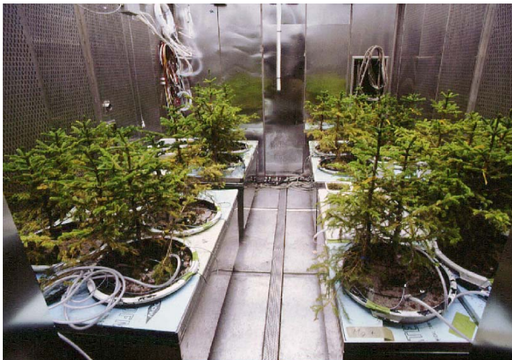
Abbildung 4-16: Klimakammer zur Begasung von jungen Fichten.
