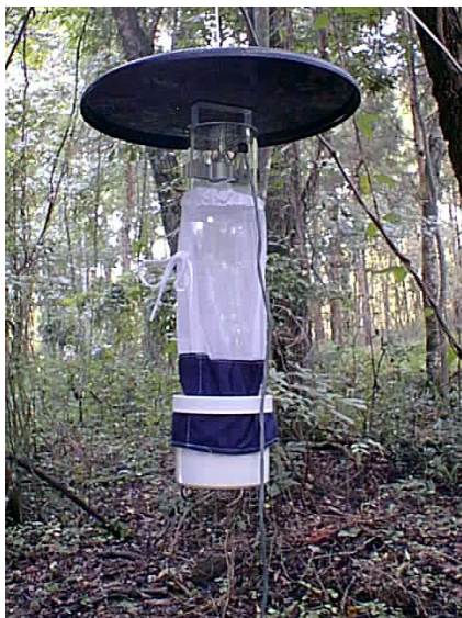
Abb. 3.1: Abgebildet ist eine Light Trap , mit welcher nachts Moskitos durch Licht und Lockstoffe angelockt und gefangen wurden.
