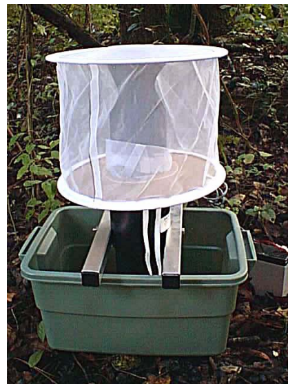
Abb. 3.2: Auf dem Foto erkennt man eine Gravid Trap , welche vorwiegend in den Morgenstunden Moskitoweibchen zur Eiablage anlockte.
