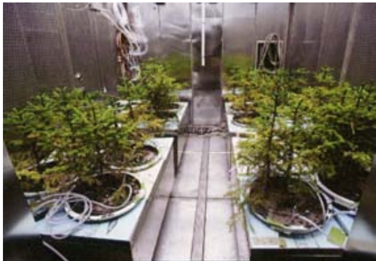
Abbildung 4-4: Klimakammer zur Begasung von jungen Fichten.
