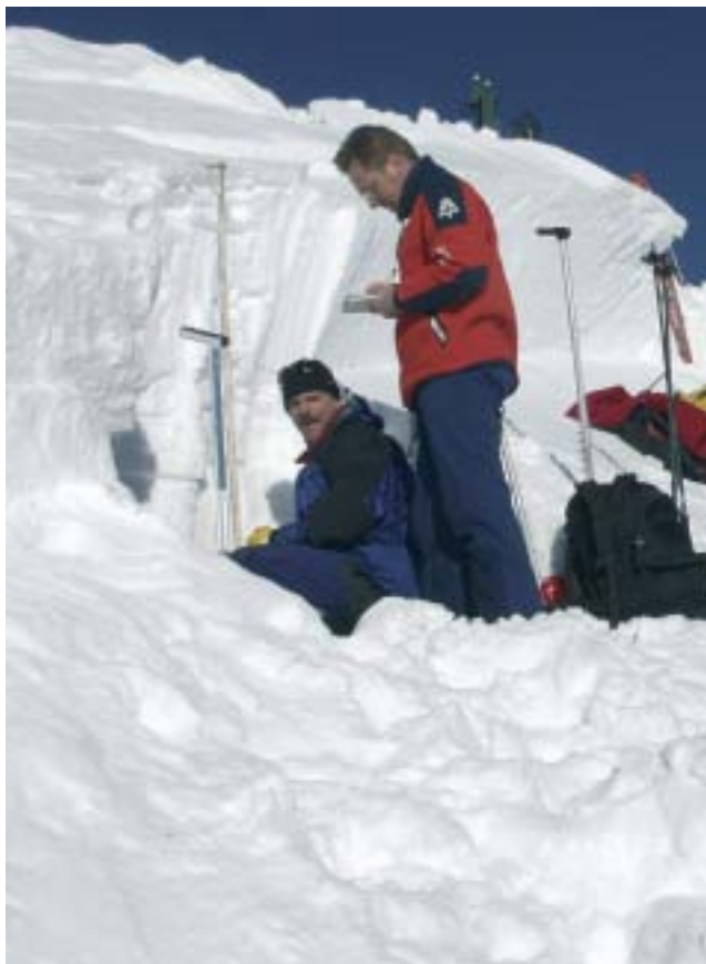
Erstellung eines Schneeprofiles, Lawinenunfall (Häselgehr, Haglertal, Tirol) vom 02.01.2002
