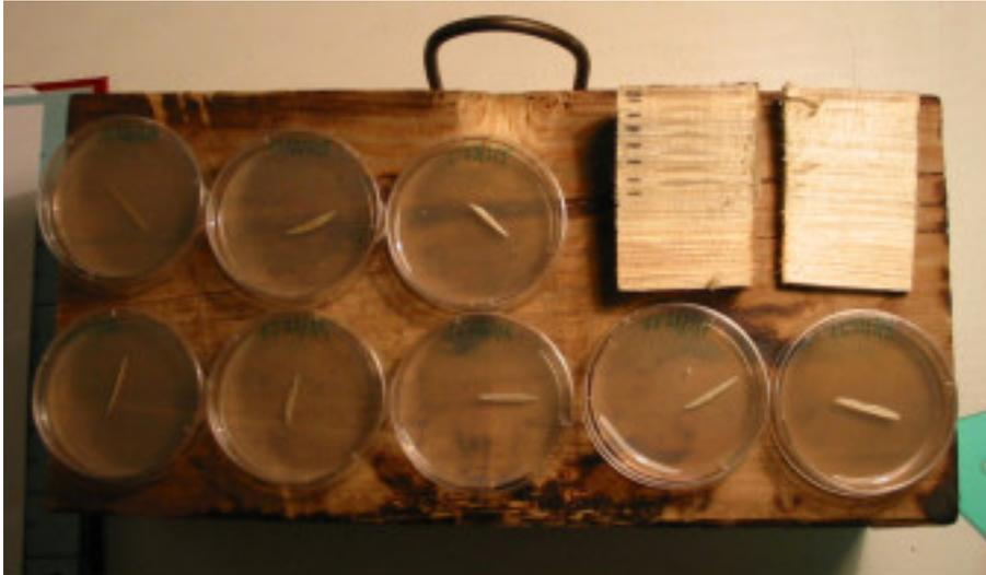
Abbildung 8: Probestücke aus denen die Holzspäne nach Tiefenstufen entnommen und auf das Nährmedium (in den Petrischalen) aufgebracht wurden.
