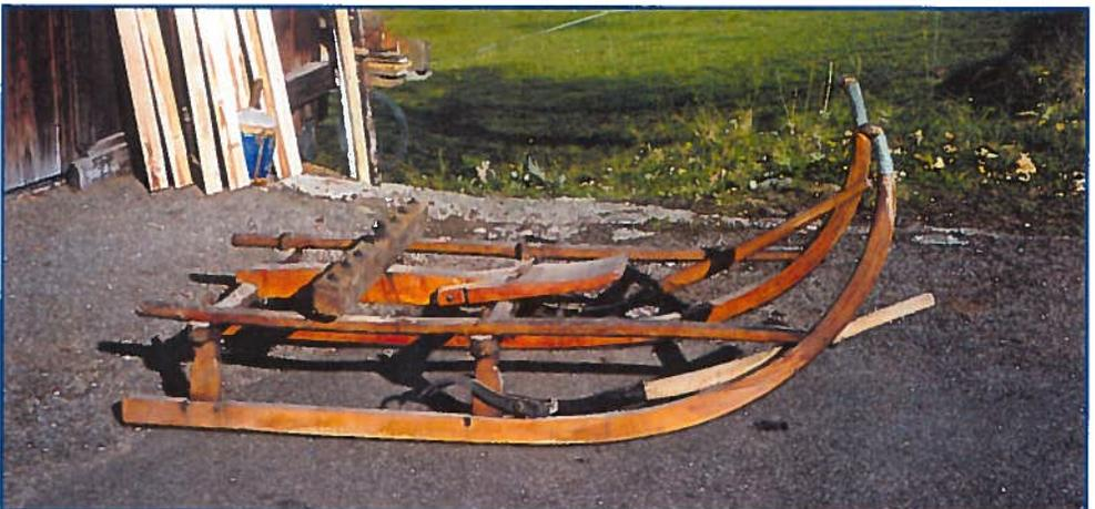
kantholz zum Tragen des Reibschemels. Dieser weist auf der Oberseite einen eigenwilligen Eisenbeschlag zum Festhalten der Bodenblöcke auf. In der Mitte ist ein Flachstahlstück mit ca. 15 – 18 cm Länge aufgesetzt, bei dem die Enden rechtwinkelig nach oben gerichtet sind.
