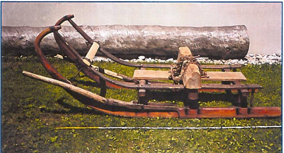
Hörner und Spanten ergeben vorne eine geschlossene „Schlaufe“. Der Nachschlitten wird mit zwei seitlichen Stangen gelenkt, die am mittleren Beinpaar angebracht sind und am hinteren, etwas vorstehenden Ebl aufsitzen. Die etwas mehr über das dritte Beinpaar ragenden Spanten werden zusätzlich mit Rundholzstäben abgestützt.
