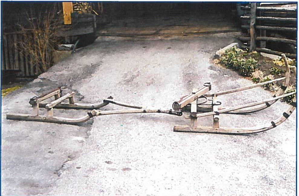
Die gegabelte Verbindungsstange ist ähnlich gestaltet wie bei Zugtierschlitten. Der Nachläufer wird mit einigen Rundgliedern am eisernen Drehkranz angehängt. Trotz der aufwändigen Ausführung des Drehkranzes lassen die zwei Beinpaare jeglichen Eisenbeschlag zur Festigung der Gesamtkonstruktion vermissen.
