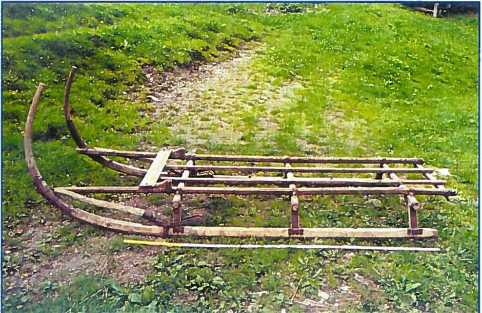
Vom Ansatzklotz hinter der schmalen Sitzleiste (10 cm breit) bis zum Ende der Längslatten ist eine 190 cm lange Ladefläche.
