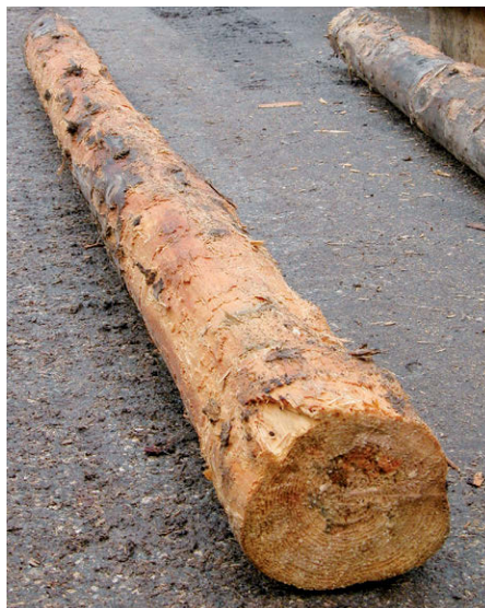
Abb. 16. Splintholzverlust nach dem Entrindungsprozess.
