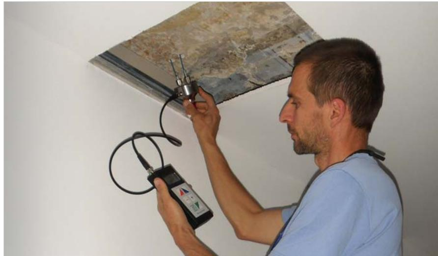
Holzfeuchtemessung an einer Dippelbaumdecke nach einem Wasserschaden.
