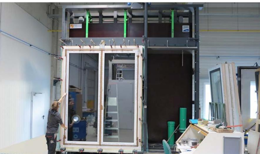
Mit dem neuen Prüfstand können noch genauere Daten über die Luftdichtheit von Bauteilen, deren Anschlüsse und Durchdringungen gewonnen werden.
