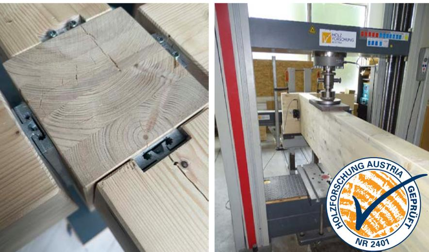
Links: Knotenausbildung mit SIHGA HobaFix® Max; rechts: Haupt-Nebenträgerprüfung an der Holzforschung Austria
