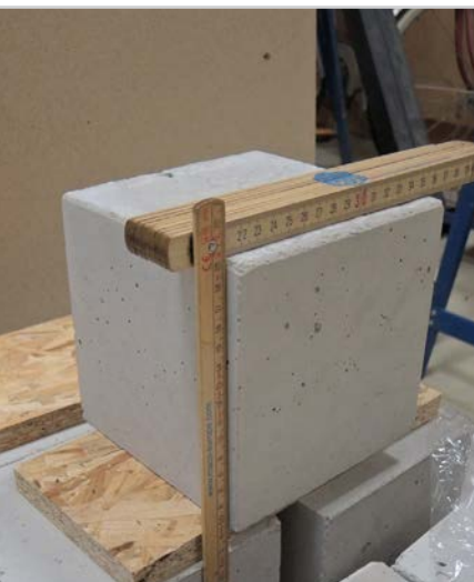
Wandsimulation: Beton auf den die Fensterprofile geklebt wurden (links) und Versuchsaufbau der Abscherprüfung (rechts)
