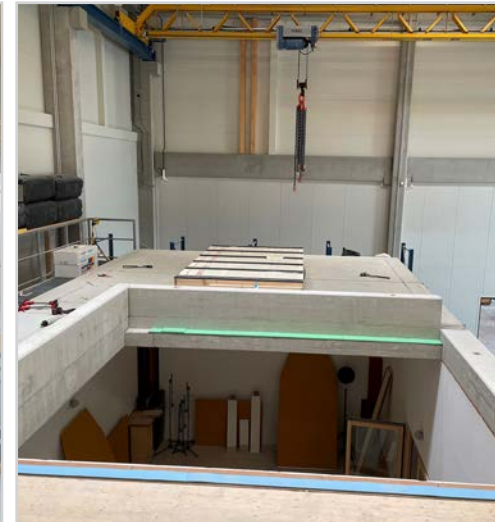
Versuchsstände der HFA zur Ermittlung des Stoßstellendämm-Maßes nach ÖNORM EN ISO 10848 unter Auflast. Links: Versuchsstand für Holzmassivbauteile im Statik-Prüffeld, rechts: geöffneter Versuchsstand für Holzrahmenbauteile im XL-Prüfstand
