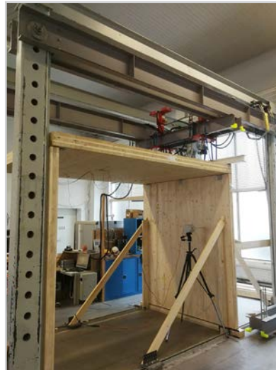
Versuchsstände der HFA zur Ermittlung des Stoßstellendämm-Maßes nach ÖNORM EN ISO 10848 unter Auflast. Links: Versuchsstand für Holzmassivbauteile im Statik-Prüffeld, rechts: geöffneter Versuchsstand für Holzrahmenbauteile im XL-Prüfstand
