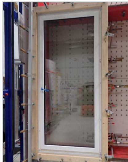
Prüfung der Tragfähigkeit eines Kunststofffensters in einer Holzwandsimulation (links) und zur Dichtheit eines Kunststofffensters in einer Betonwandsimulation (rechts)
