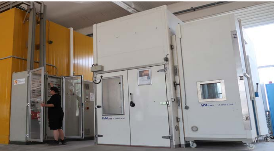
Zwischen den beiden Schalen der Differenzklimakammer wurden einzelne Fensterprofile (keine Rahmen) mittels Montageschrauben befestigt und die Längenänderung der Profile mittels Messtaster bestimmt
