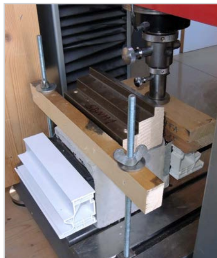
Wandsimulation: Beton auf den die Fensterprofile geklebt wurden (links) und Versuchsaufbau der Abscherprüfung (rechts)
