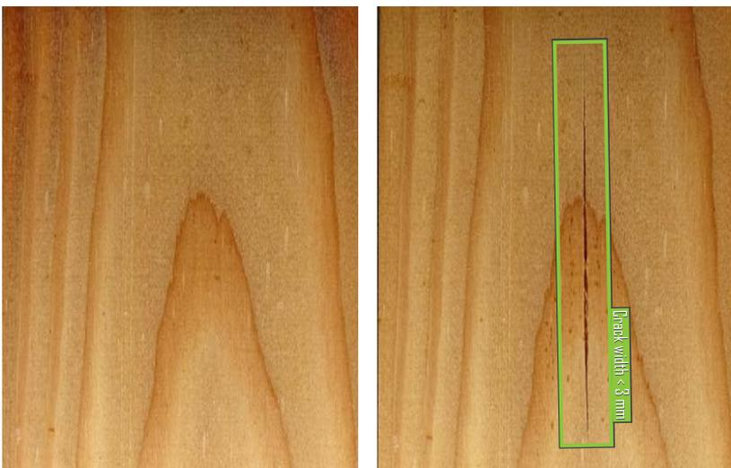
Versuch zur Verfolgung der Rissbildung. links: Probe im trockenen Zustand; rechts: Probe nach beschleunigter Abtrocknung mit Heißluftgebläse und Risserkennung mittels Computer Vision Methoden.
