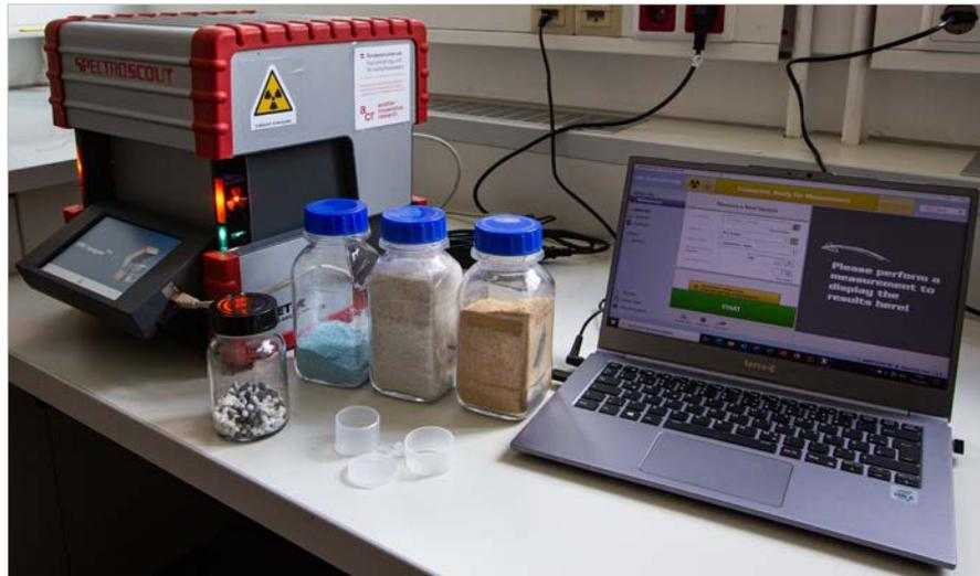
Analyse von Dämmstoffen mit dem Röntgenfluoreszenz-Analysator
