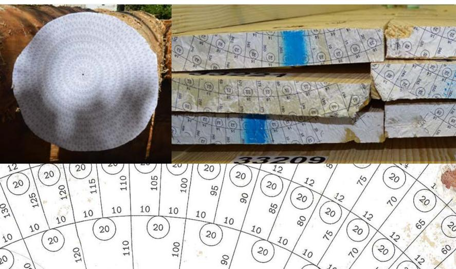
Mit auf die Stirnfläche geklebten speziell bedruckten Folien konnte für jedes Brett die genaue Position im Stamm dokumentiert und rekonstruiert werden.
