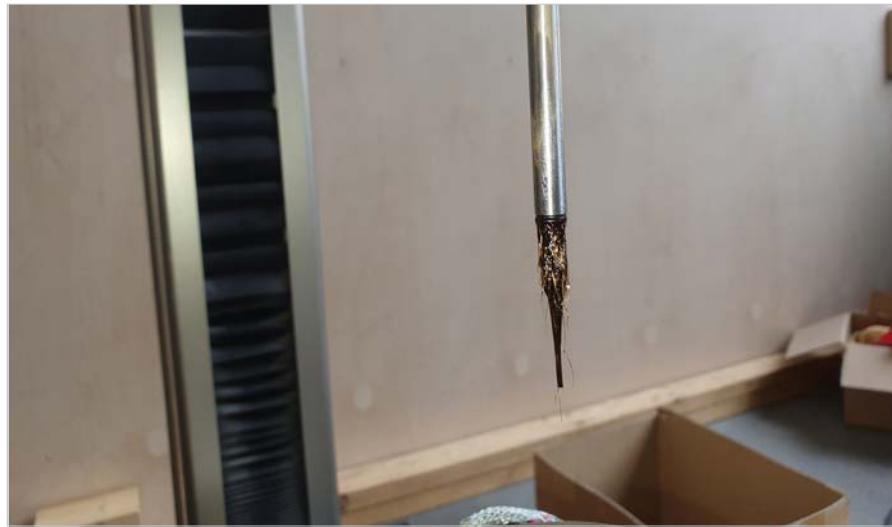
Die Verpressung von reinem Lignin in der Single Pellet Presse bei 300 MPa führt zu vollständiger Verglasung und starker Haftung zwischen Stahl und Lignin.
