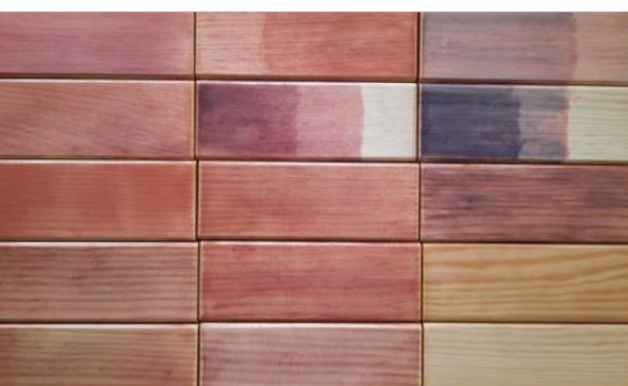
Beschichtete Holzproben mit pilzproduzierten Pigmenten
