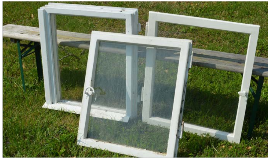
Altfenster sind aufgrund ihrer Materialkombination eine Herausforderung beim Recycling
