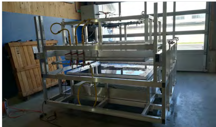
Neu entwickelter Prüfstand für die Prüfung der Regensicherheit von Unterdachsystemen
