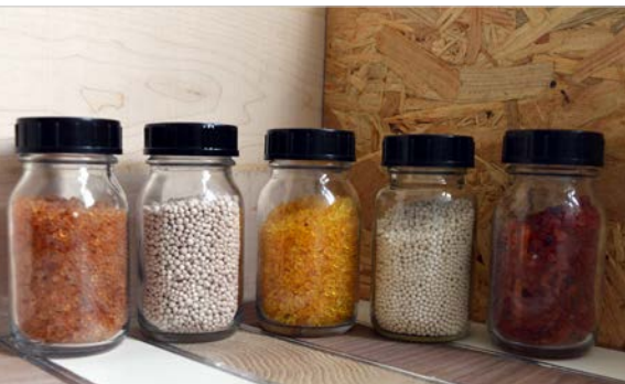
Im Forschungsprojekt IASca wurden verschiedene Scavenger-Materialien auf ihre Fähigkeit, VOC dauerhaft zu binden, untersucht
