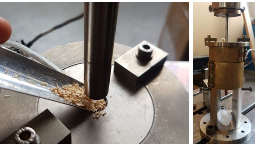
Einfüllen des Rohstoffes in die Single Pellet Presse (SPP) der Holzforschung Austria
