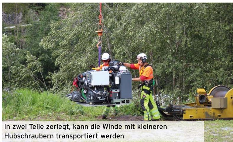
In zwei Teile zerlegt, kann die Winde mit kleineren Hubschraubern transportiert werden
