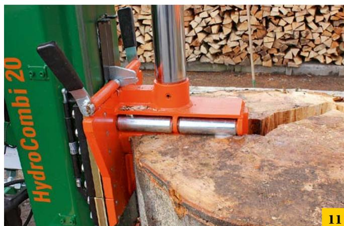
hubdistanz des Spaltmessers schnell verändert werden. Hierfür ist lediglich eine Flügelmutter zu lockern und die Abschaltstange in die gewünschte Position zu bringen. Die maximalen Holzlängen zum Spalten liegen bei etwa 110cm. Hier gilt die Devise: Gewissenhafte Ausformung im Vorfeld spart Zeit und garantiert den besten Arbeitserfolg! Steht nur das Spalten kürzerer Ausformungsstücke am Programm, wäre auch die Nachrüstung eines Spaltti-
