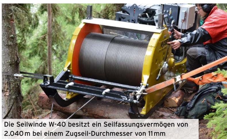
Die Seilwinde W-40 besitzt ein Seilfassungsvermögen von 2.040 m bei einem Zugseil-Durchmesser von 11 mm
