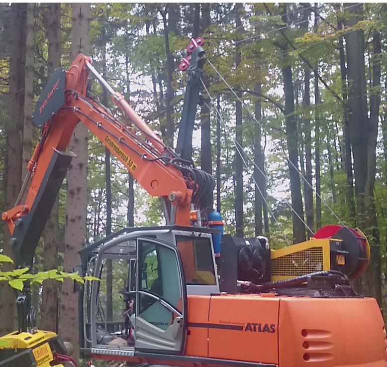
Windenkasten und Hydraulikturm, montiert auf einem Prozessorbagger.
