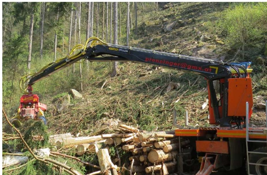
Bei maximaler Ausladung des Epsilon-Krans bleibt noch genügend Hubkraft, um dicke Stämme zu bearbeiten
