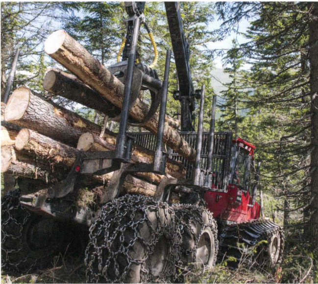
Eine bodenschonende Rückung ist mit dem Komatsu Forest Forwarder 860.4 möglich.
