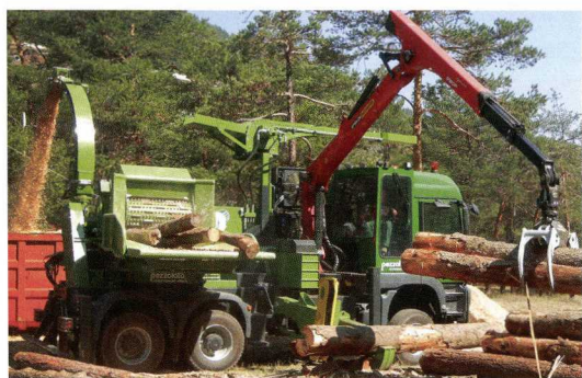
Hackertruck PTH 1200/820 von Pezzolato ist mit preisgekrönten, abklappbaren Gegenmessern gegen Schäden durch Fremdkörper ausgestattet. Foto: EiFo
