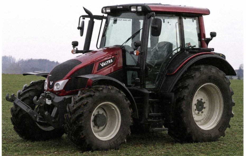
Valtra-Traktor N 103 HiTech 5 ist mit einer leistungstarken fünfstufigen Lastschaltung sowie mechanischer Hydrauliksteuerung ausgestattet.
