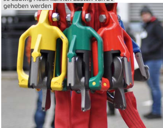
Je Ludwig Hook können Lasten von 2 t gehoben werden
