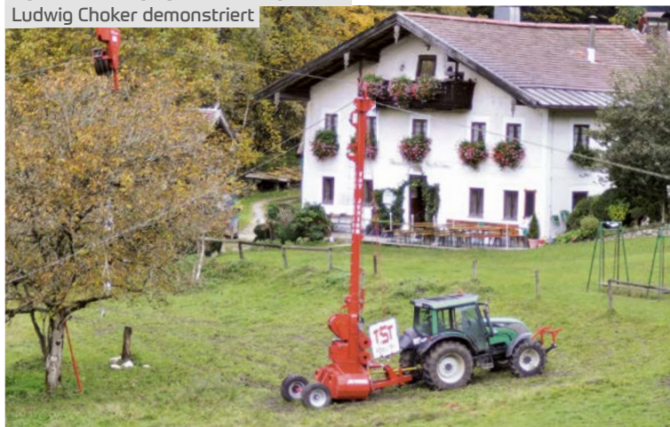
Je Ludwig Hook können Lasten von 2 t gehoben werden
