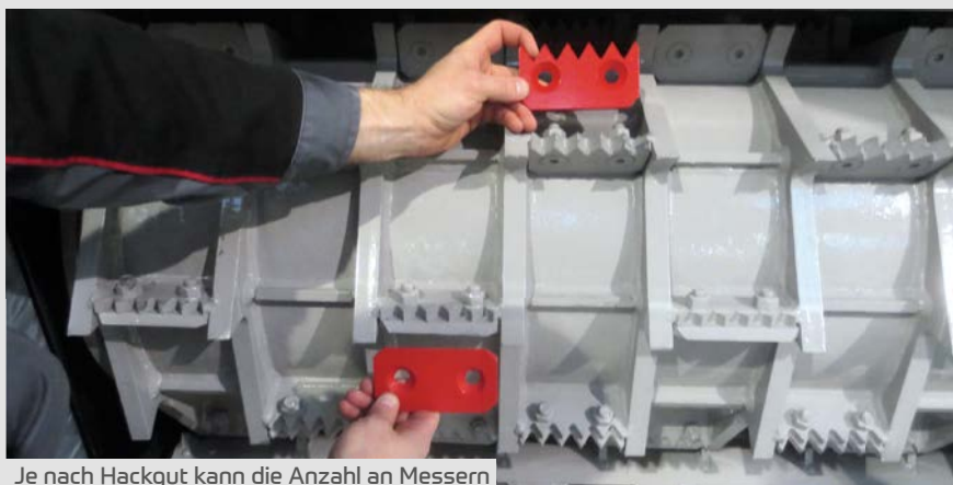
Die anschraubbaren Messerklingen können bei Verschleiß umgedreht werden
