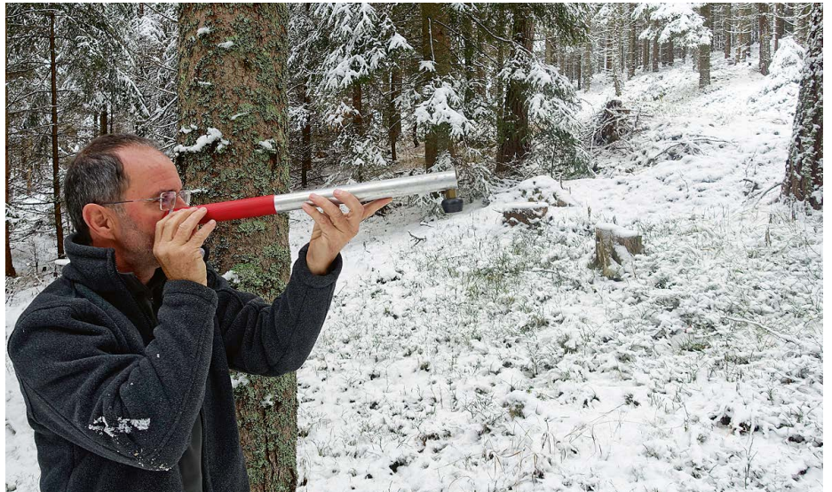
Ist es ein Bedränger dieses Z-Baumes oder nicht? Himmelbauer mit einer selbst entwickelten Prüflöhre
