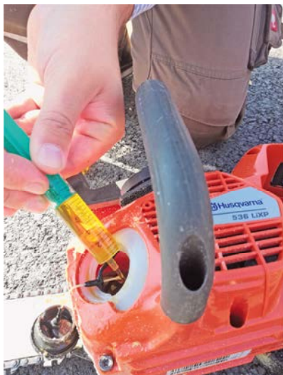
Abbildung 3: Ermittlung des Kettenölverbrauchs der Motorsägen mittels Kunststoffspritze
