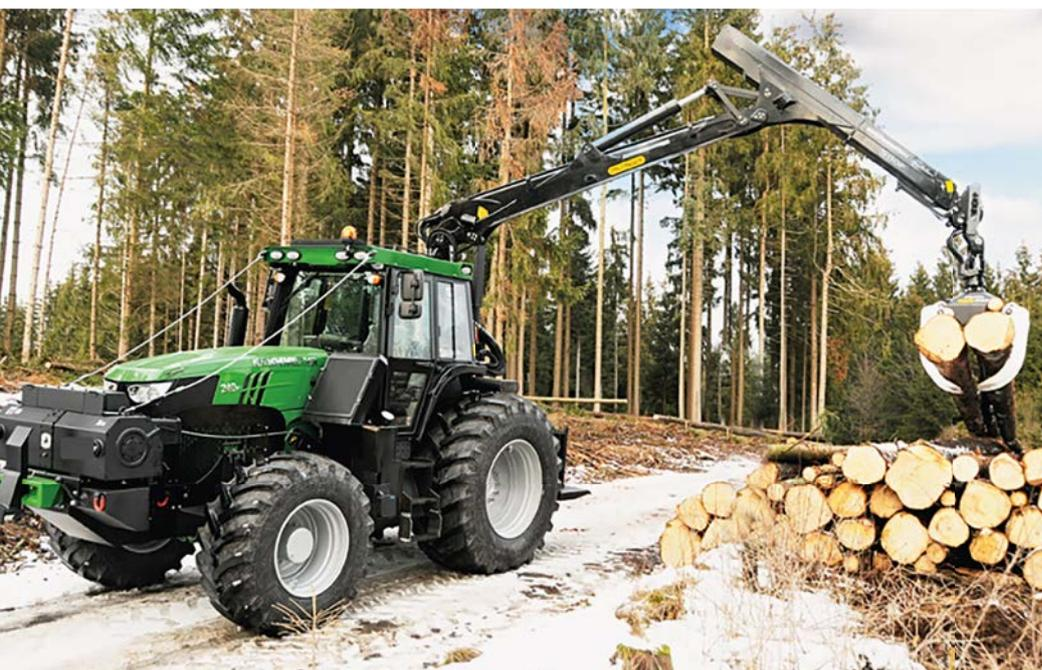
Abbildung 2: Kranrückeschlepper Typ „Kotschenreuther 240 R“ (Werkbild Kotschenreuther)
