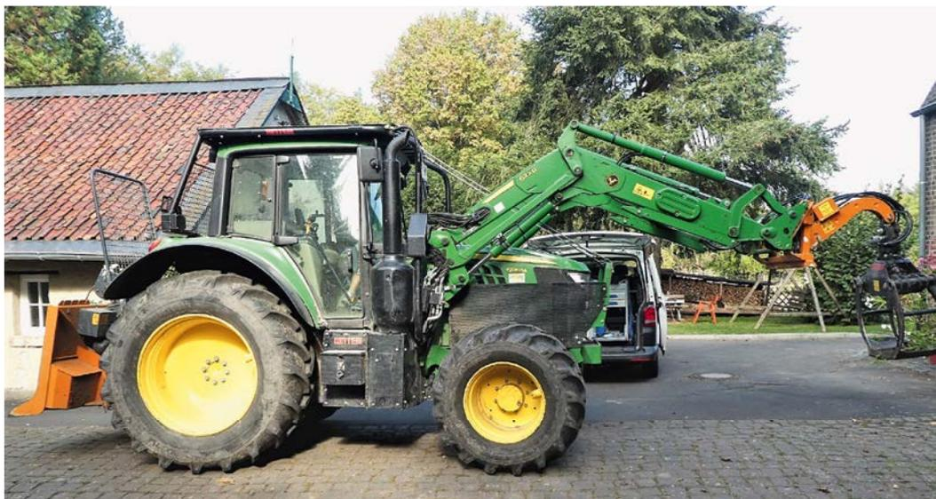
Abbildung 7: Forstraktor Typ „John Deere 6120 M“ mit Forstausrüstung Bauart Ritter (Bild Lenz)
