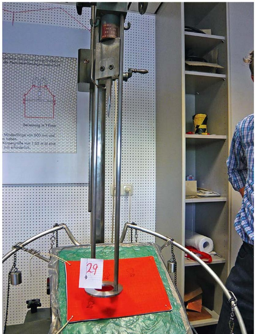
Abbildung 2: Der gewichtsbelastete Prüforn fällt nach Abschalten eines Elektromagneten auf das in schrägem Winkel aufgespannte Prüfmuster. Dadurch wird der Tatsache Rechnung getragen, dass Angreifende Keiler in einer halbkreisförmigen Bewegung schlagen.
