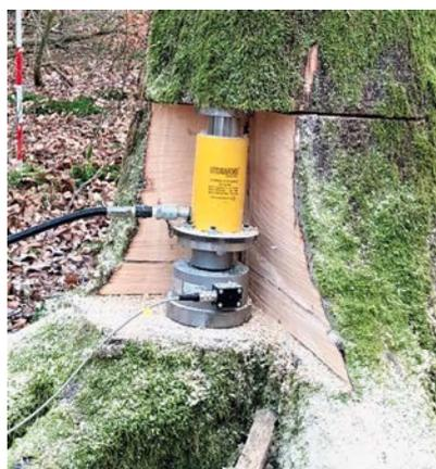
Abbildung 11: Montierte Kraftmesseinrichtung
