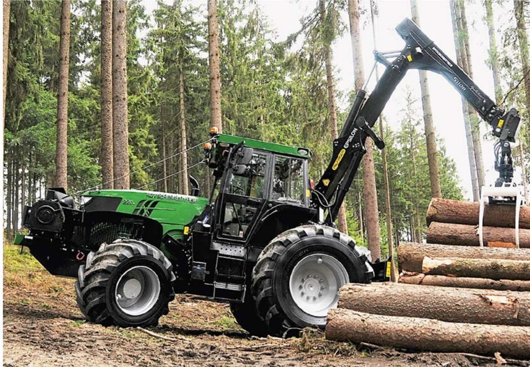
Abbildung 3: Kranrückeschlepper Typ „Kotschenreuther 260 R“ (Werkbild Kotschenreuther)
