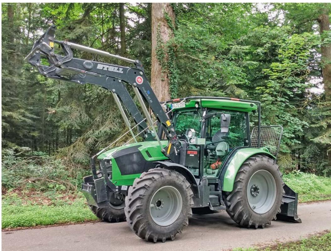
Abbildung 8: Forstraktor Typ „Deutz 5100 G“ mit Forstausrüstung Bauart Ritter (Bild Lippert)
