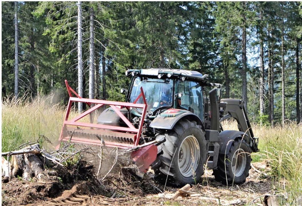
Abbildung 4: Forstraktor Valtra Typ „N 174 Direct“ (Bild Weise)
