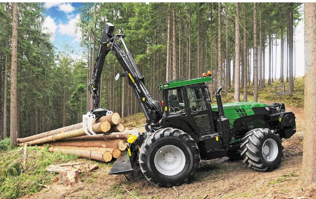
Abbildung 1: Kranrückeschlepper Typ „Kotschenreuther 220 R“ (Werkbild Kotschenreuther)
