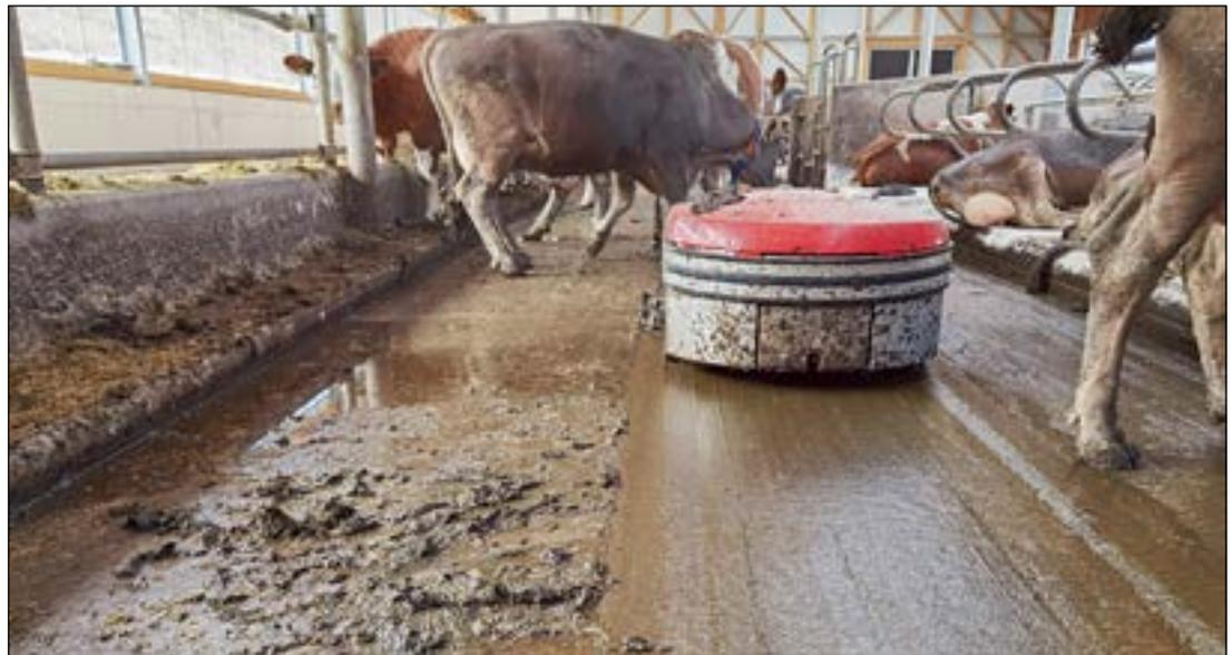
Der Lely Collector saugt die Gülle vom Boden ab. Die Routen können je nach Verschmutzungsgrad frei programmiert werden, auch Zwischengänge und Ausläufe werden mitgereinigt.
