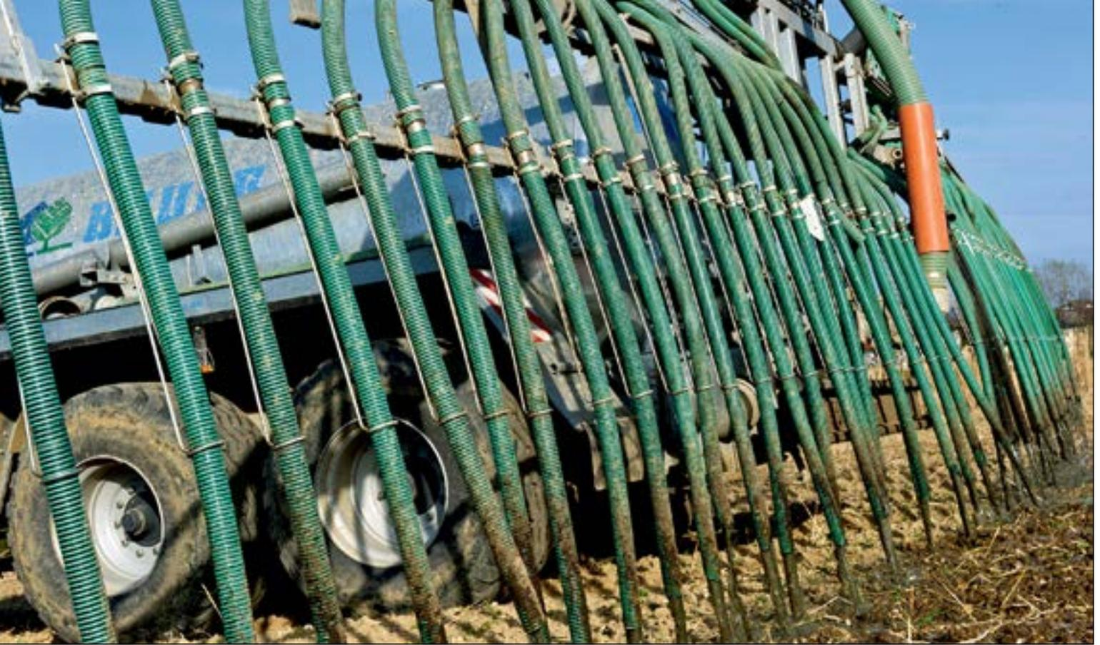
Die bodennahe streifenförmige Ausbringung erlaubt es, in Grünland- und Acker(futter)bestände Gülle möglichst verlust- und verschmutzungsarm auszubringen.
