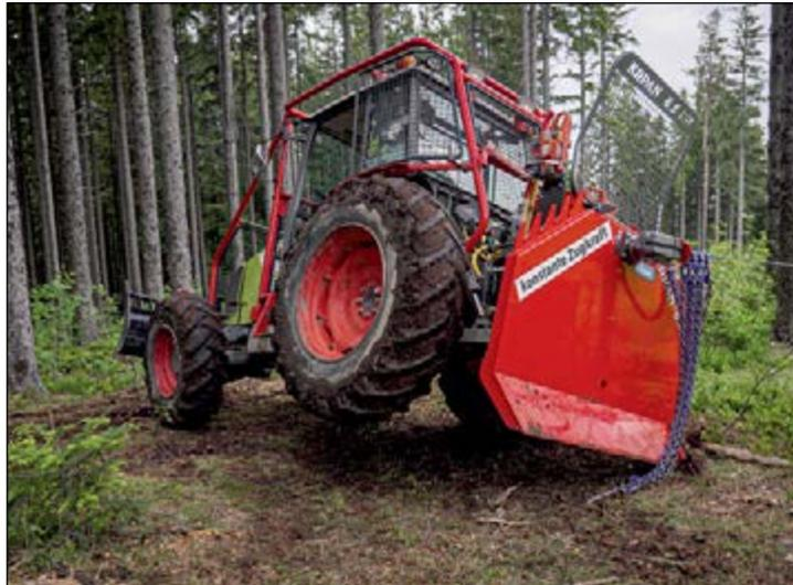
Seil, während die Kupplung das Antriebsmoment auf die Seiltrommel überträgt. Die Seilbremse hält das Zugseil bei Zug auf Spannung, beim Abspulen bremst sie das Zugseil ab und verhindert ein unkontrolliertes Abspulen.
