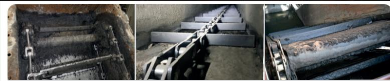
BRENNSTOFFZUFUHR – ANNAHMEKETTENFÖRDERER – ASCHEAUSTRAG – SUBSTRATFÖRDERER
