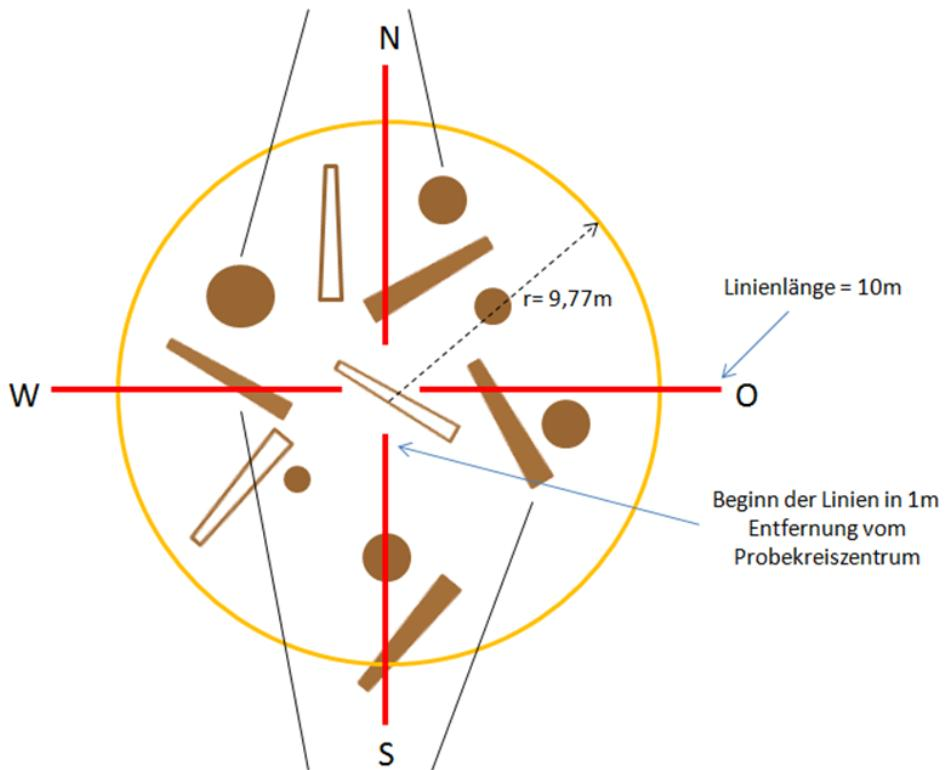
Liegende Elemente werden mittels Linien-Intersektion aufgenommen
