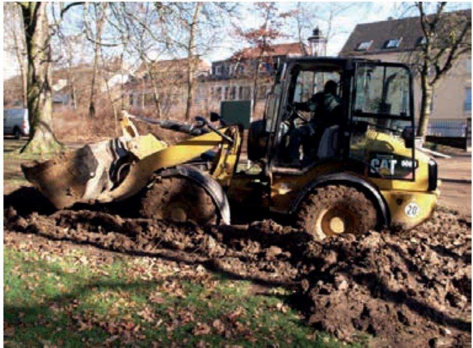
Abb. 2: Massive Gefügeschädigung durch Befahrung ungeschützter Böden mit dafür ungeeigneten Fahrzeugen.
