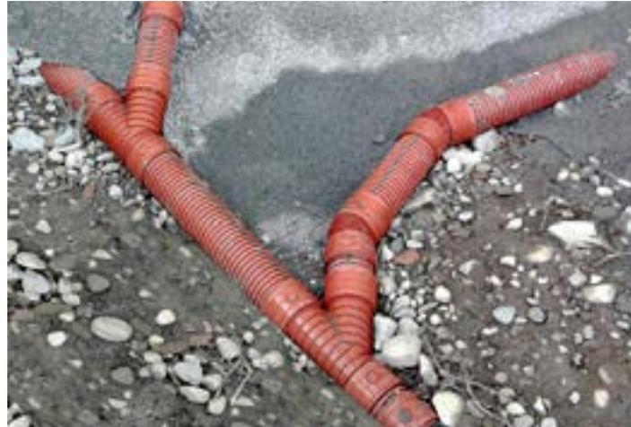
denn im Gegensatz zum Drainage-Schlauch kann das PP-MEGA-Drän ganz einfach mit einer Kanalratte gereinigt werden.
