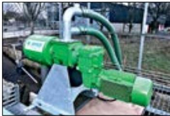
Die Voitsberger Bauer Group präsentiert den Klein-Separator S300 auf der Austro Agrar. Das Gerät, Nachfolger des Separators COMPACT, ist für den Einsatz in Betrieben ab einem Viehbestand von 30 Tieren gedacht. Die niedrigen Anschaffungskosten, der einfache Aufbau sowie die hohe Qualität der Komponenten machen den S300 zu einer sinnvollen Investition für Betriebe dieser Größenordnung.
