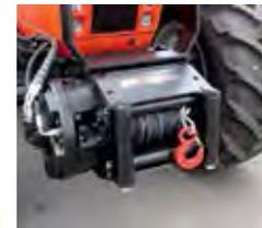
**CRANIT-Getriebe-Seilwinden hydraulisch 7 t,**
