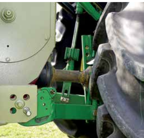
Hydraulischer Seilausstoß mit automatischer Abschaltung beim Seileinzug. Beim Anbau der Winde soll die Stellung der Zapfwelle möglichst waagrecht sein.
