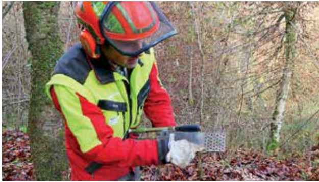
Der mechanische Fällkeil sorgt für eine erschütterungsfreie Fällung.
