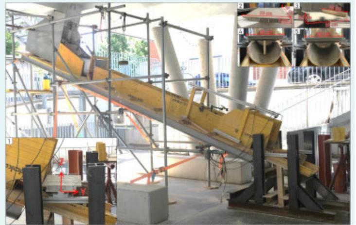
Abbildung 3: Versuchsaufbau gesamt (großes Bild), 1: Detailsicht der Miniaturbrücke am Stahlrahmen, 2 und 3: Beispiele für Brückenprofile, 4: Setup mit Pfeiler, 5: Setup ohne Pfeiler
