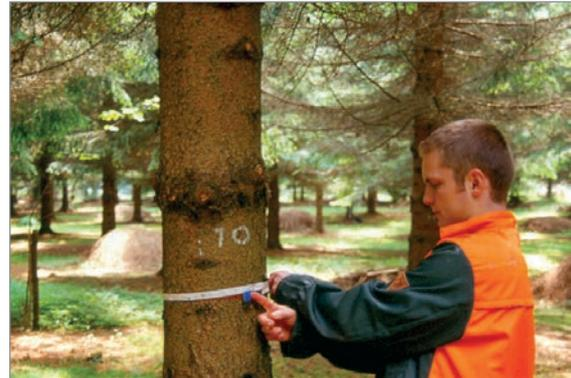
Abbildung 15: BHD-Messung mit Umfangmaßband
