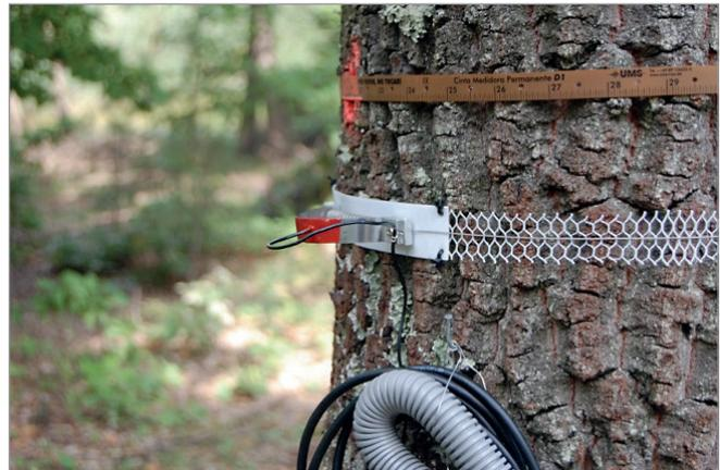
Abbildung 13: Permanentes BHD-Messband und elektronisches Dendrometer
