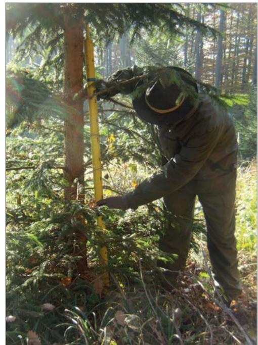
Abbildung 17: Baumhöhenbestimmung mit Messlatte
