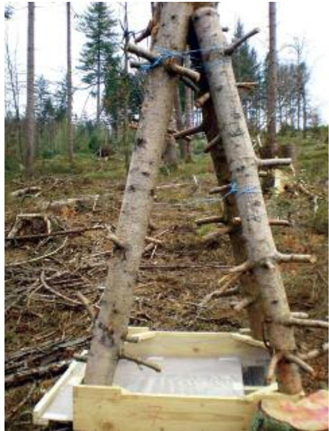
Abbildung 2: Prügelfalle auf Auffangvorrichtung mit geöffneter Fanglade.
