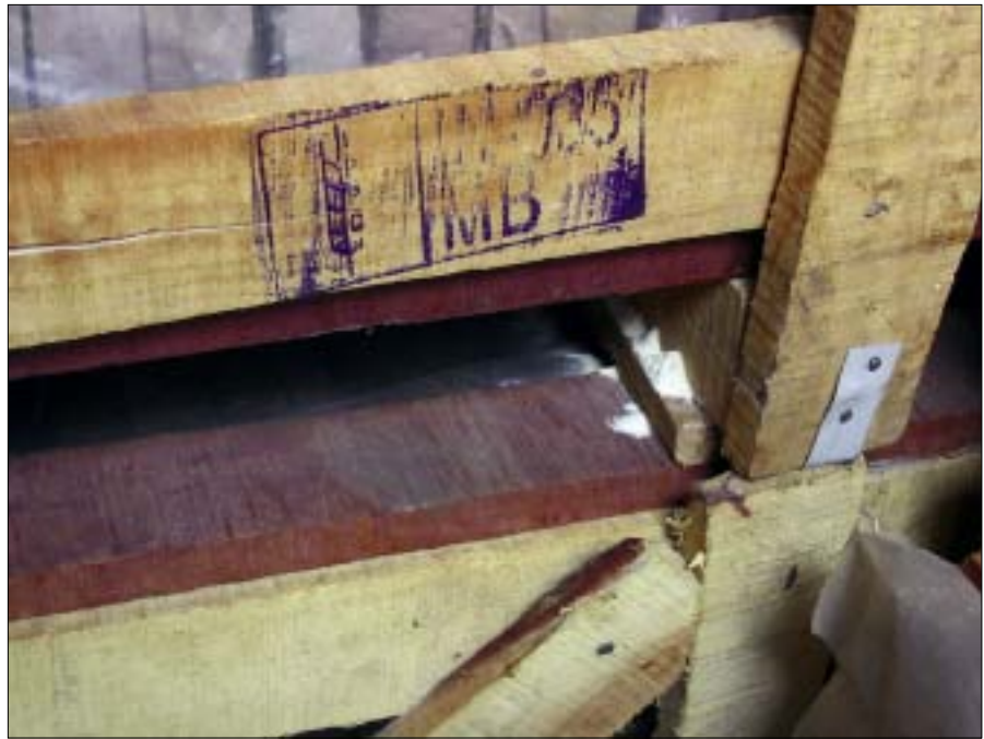
Abbildung 1: „Behandeltes“ Verpackungsholz mit IPPC-Markierung und Bohrmehl von lebenden Insekten
