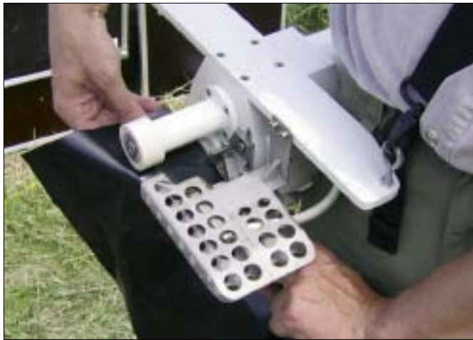
Abbildung 3: Gerät zum Verschweißen der Folien
