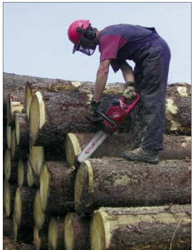
Abbildung 2: Entfernen von scharf- kantigen Blochteilen an der Oberseite des Ganter zum Schutz der Plastikfolie
