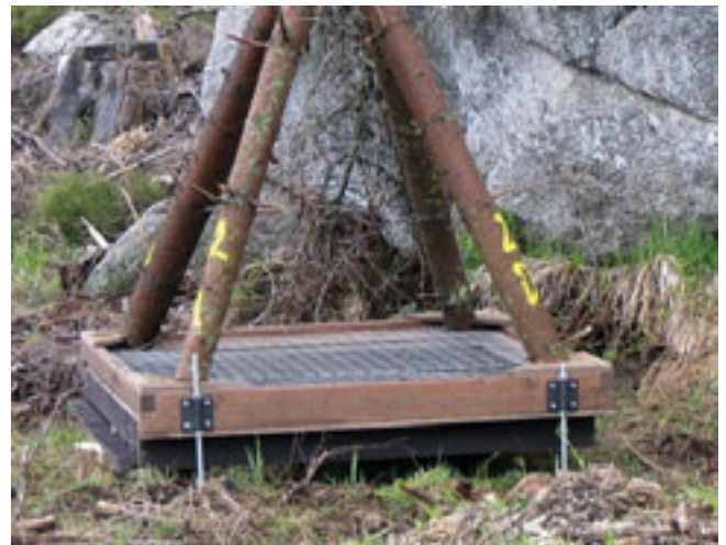
Abbildung 2: Eine Ladenkonstruktion erleichtert die Analyse des Fangergebnisses.
