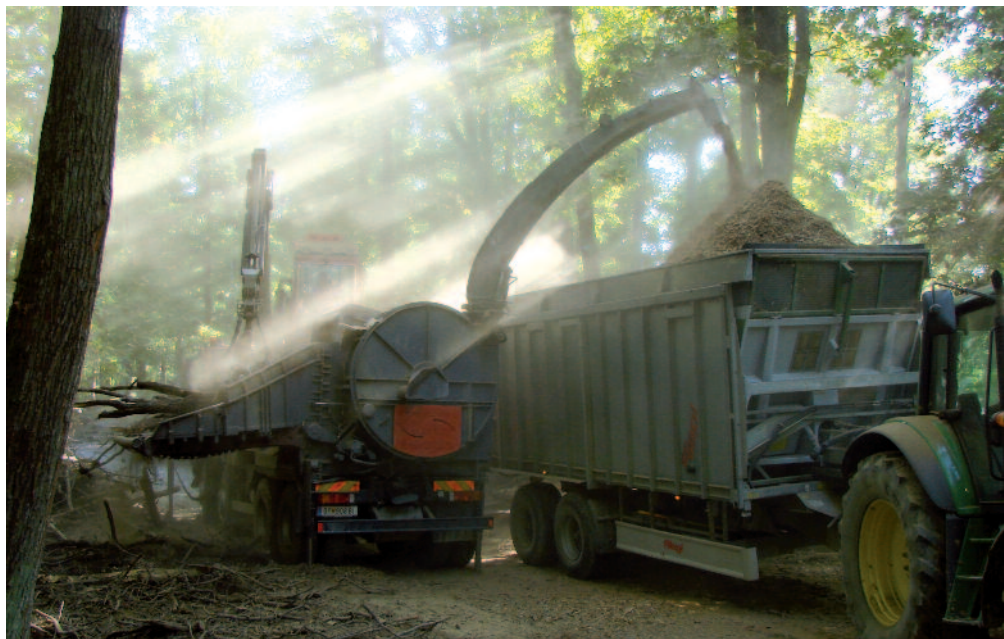
Länger gelagertes Astmaterial neigt zu starker Staubentwicklung beim Hacken
