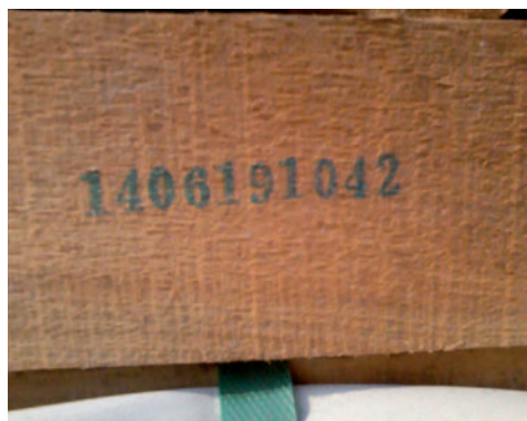
◀ Abbildung 4: China verpflichtet die Produzenten, auf das behandelte Holz die Chargennummer aufzustempeln
