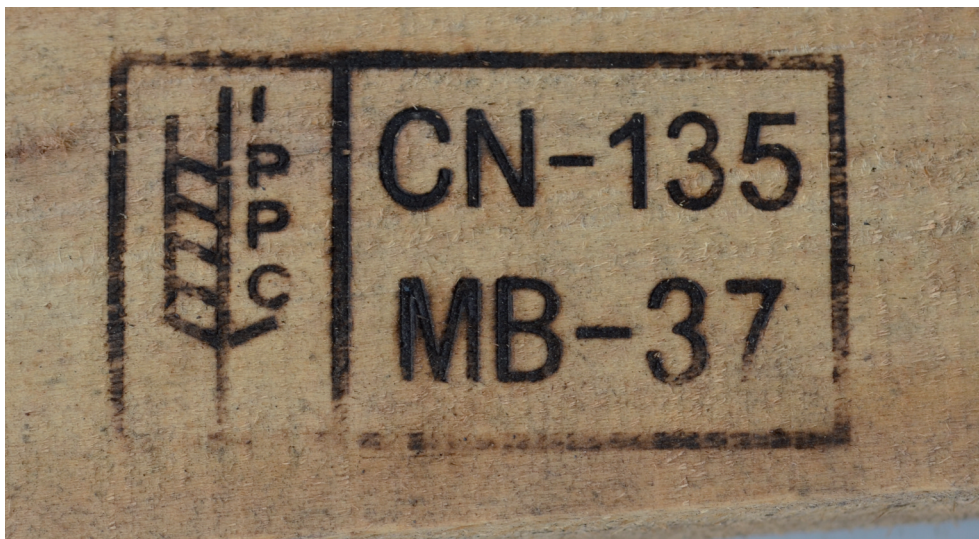
◀ Abbildung 3: Die IPPC-Ähre im linken Feld der Markierung ist verpflichtend
