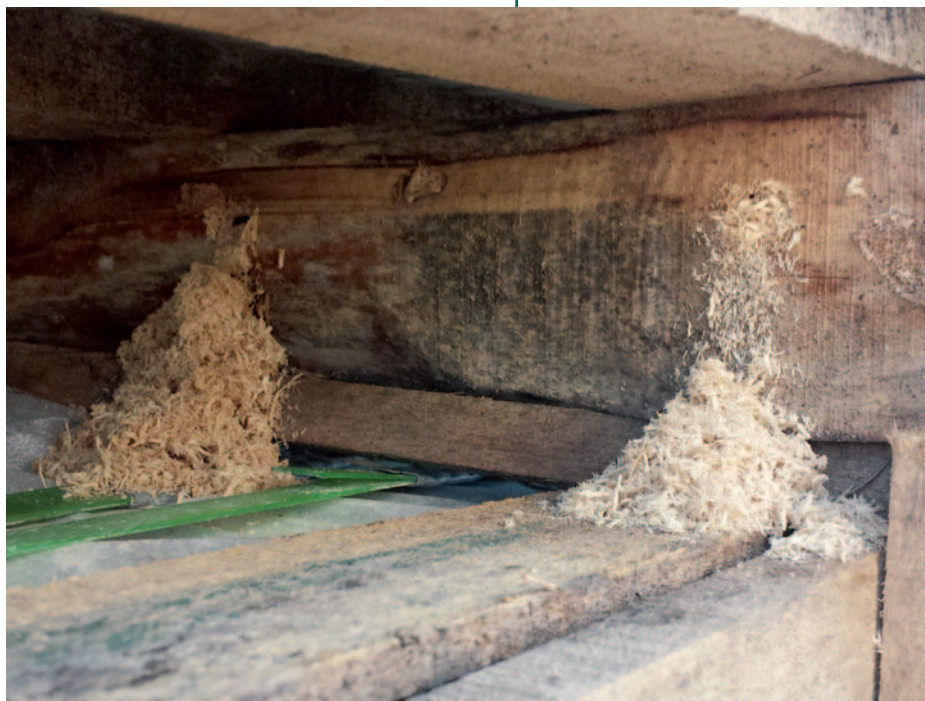
Abbildung 1: Bohrmehl ist ein leicht erkennbares Indiz für eingeschleppte Insekten
