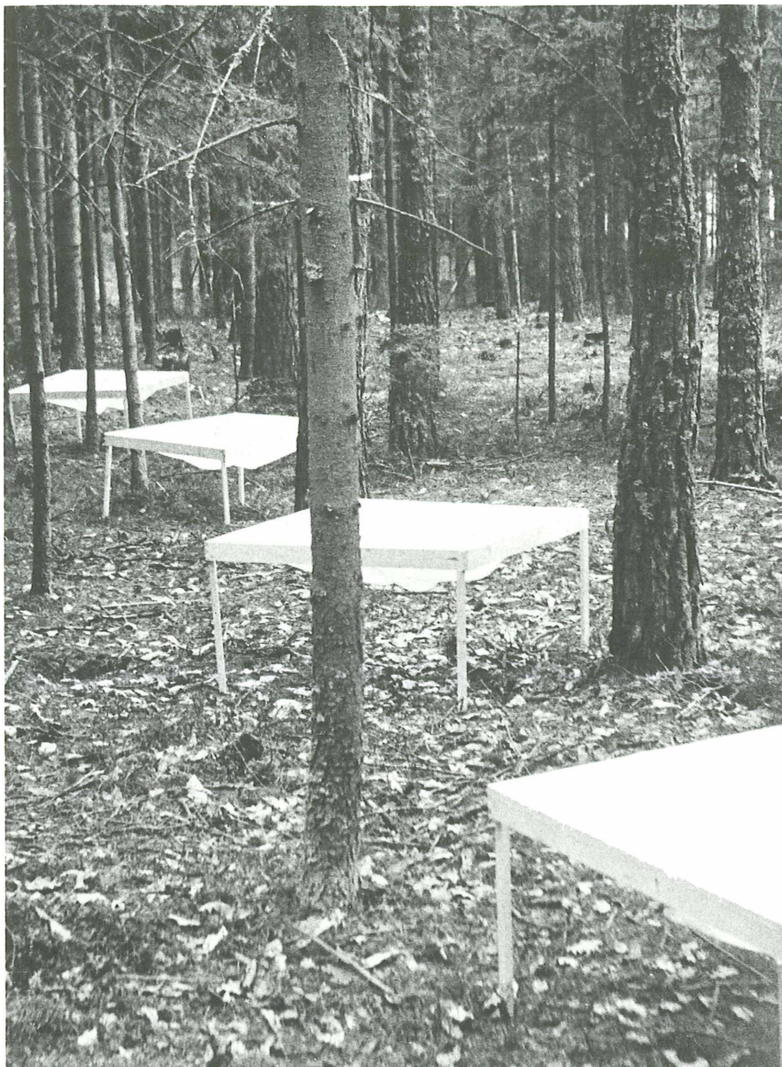
Abbildung 7: Auf den ertragskundlichen Probeflächen waren senkrecht zur Flugrichtung je 4 mit Gaze bespannte Holzgerüste zum Auffangen des Düngemittels aufgestellt, die Menge wurde gewogen.
