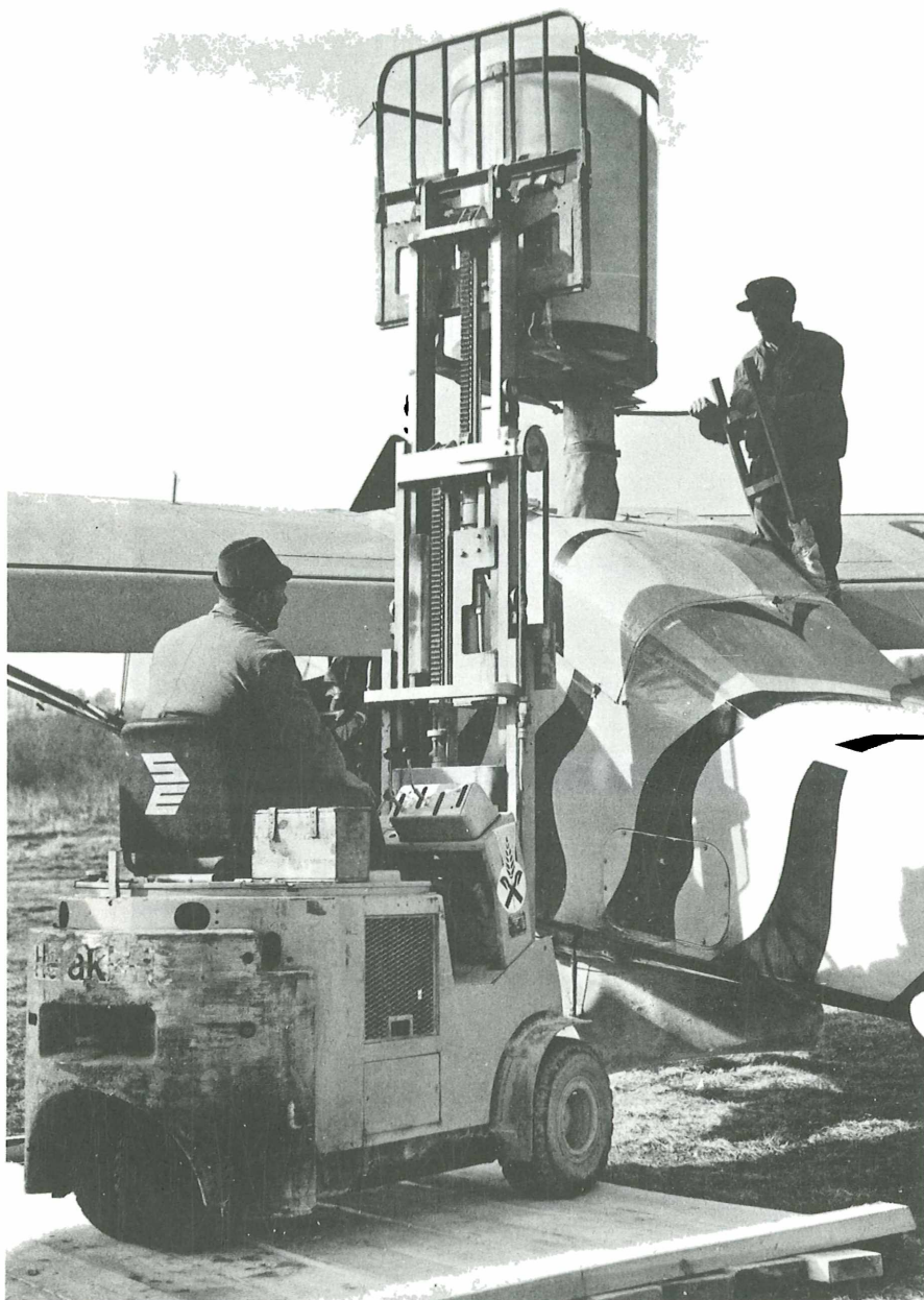
Abbildung 2: Auf einem Hubstapler montierte Beladevorrichtung. Durchschnittliche Beladezeit: 2,5 Minuten/Start.
