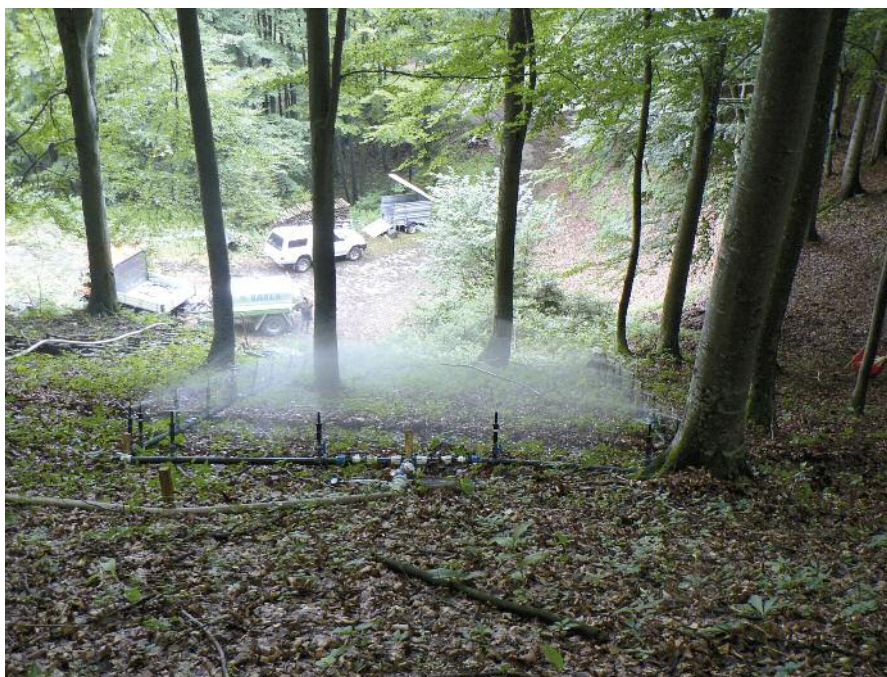
Abbildung 2: Starkregensimulation in einem Mischwald (Einzugsgebiet Weißenbach) zur Bestimmung des Oberflächenabflusses und der Infiltrationsleistung
