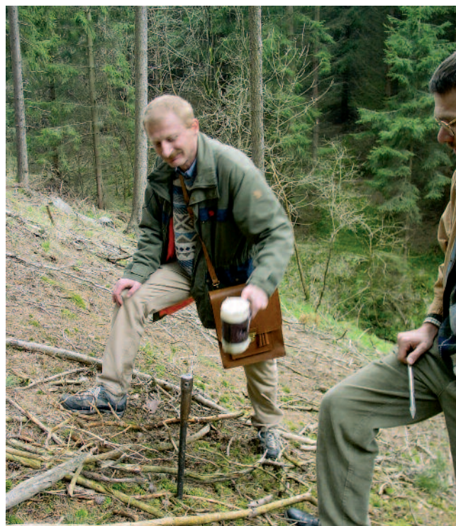
Abbildung 3: Standortserhebung: Ermittlung der Boden Gründigkeit mittels Pürckhauer-Bohrer
