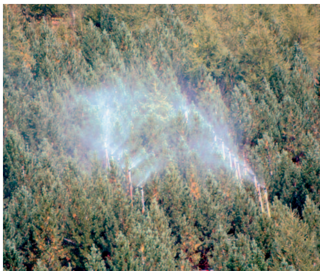
Abbildung 1: Beregnungsversuch, um die Interzeptionsleistung eines 25-jährigen Zirbenbestands zu ermitteln
