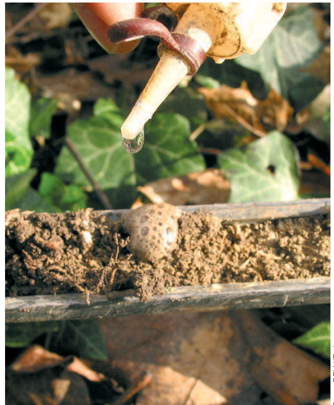
Salzsäuretest zur Karbonatbestimmung im Mineralboden
