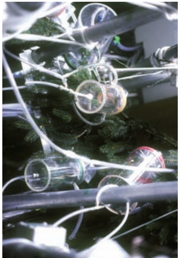
Abbildung 3-13: Küvetten zur Begasung von Fichtenästen im Freiland (Foto: Plattner).
