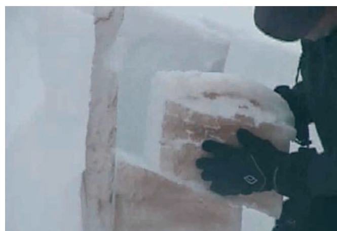
Abbildung 6: Gleitschicht im Kompressionstest
