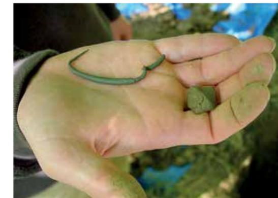
Je dünner der Boden zwischen den Fingern ausrollbar ist, desto mehr Tonanteil ist im Boden.
