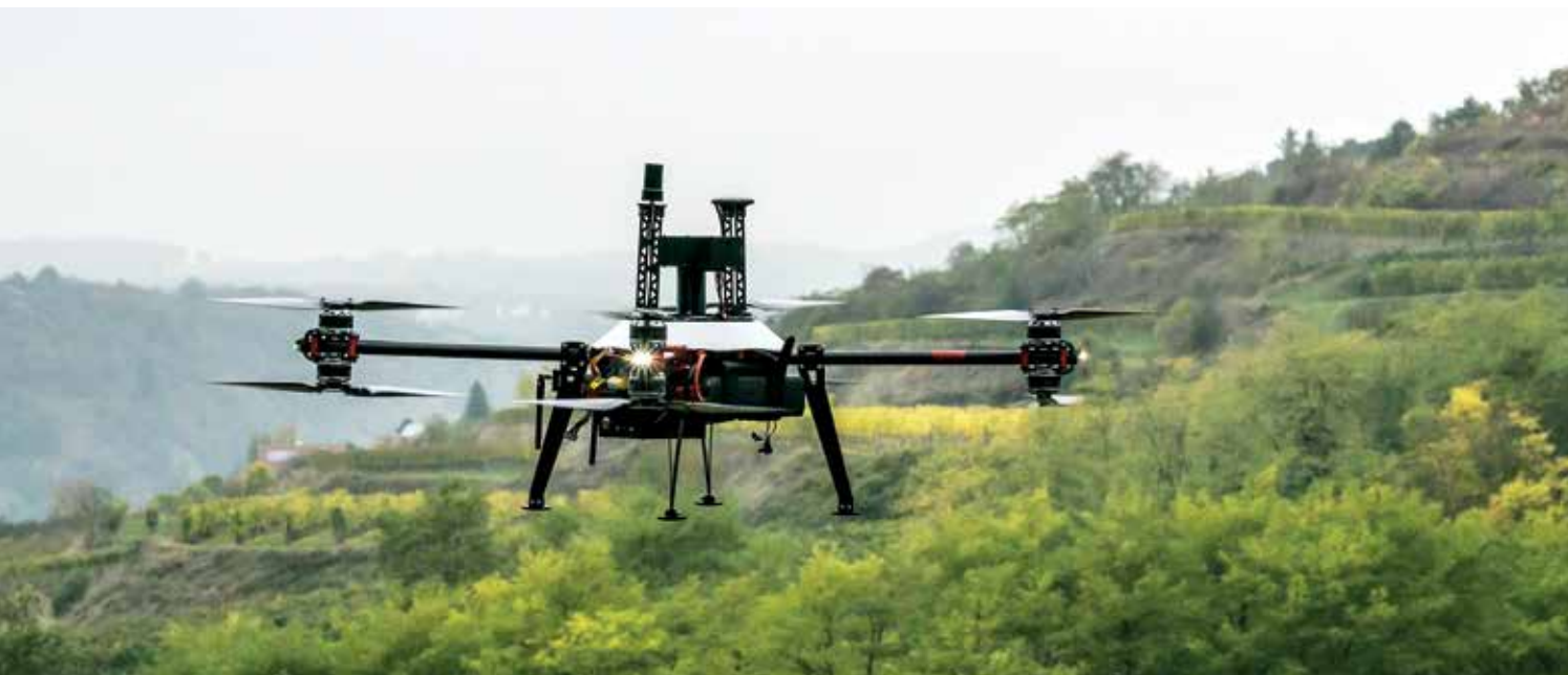
Soll ein Multicopter einen Laserscanner tragen, muss er aktuell für eine Gewichtsklasse bis zehn Kilogramm ausgelegt und bei der Austro-Control zugelassen sein.
